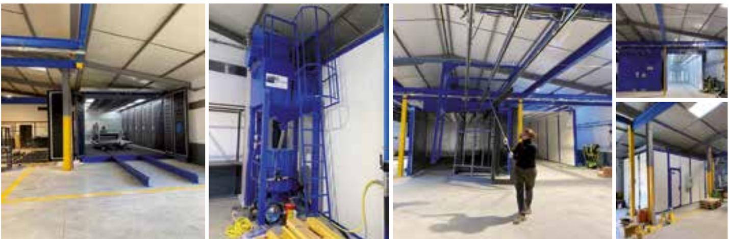
CABINE DE GRENAILLAGE - ELEVATEUR A GODET - CONVOYEUR - CABINE DE METALLISATION ET POUDRAGE
