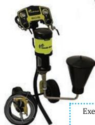
Exemple de godet monté sur pompe 15C25
